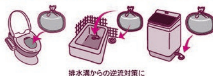
排水溝からの逆流対策に
